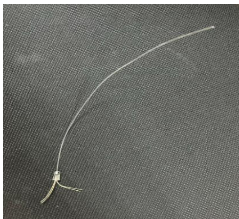
Рисунок 1.13 – Оптолокно, подсоединенное к светодиоду
