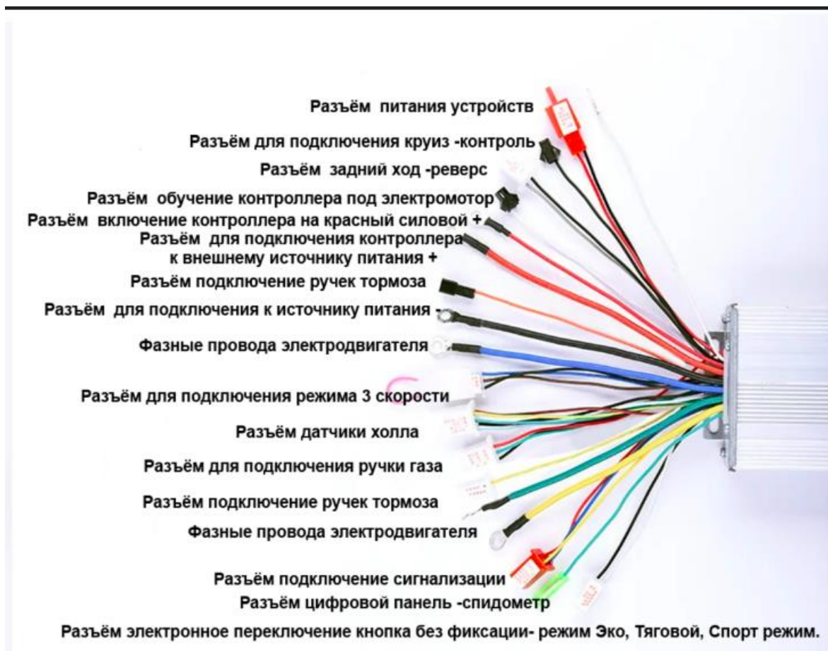
Рисунок 3.7 – Схема подключение контроллера
